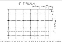
STARTING 3" FROM THE EDGE OF THE ISOLATED FLOOR, SCREW FIRMLY TOGETHER BY USING 1-1/2" SCREWS AT MAXIMUM 6" O.C.E.W. DO NOT USE SCREWS LONGER THAN COMBINED PLYWOOD (& OPTIONAL SLEEPERS) THICKNESS.
